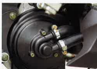
Pumpe der Wasserkühlung
